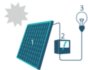
1. Zonnepaneel | 2. Omvormer | 3. Elektrische toestellen
