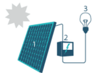
1. Zonnepaneel | 2. Omvormer | 3. Elektrische toestellen
