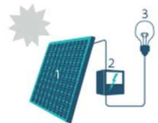
1. Zonnepaneel | 2. Omvormer | 3. Elektrische toestellen
