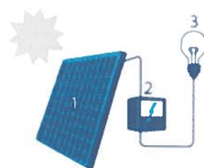
1. Zonnepaneel | 2. Omvormer 3. Elektrische toestellen
