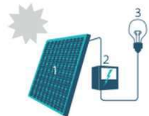
1. Zonnepaneel | 2. Omvormer 3. Elektrische toestellen
