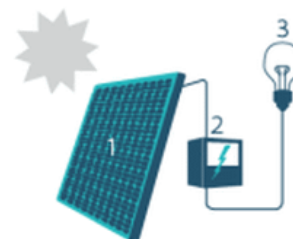
1. Zonnepaneel | 2. Omvormer | 3. Elektrische toestellen
