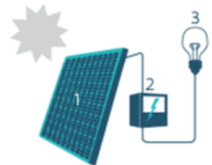
1. Zonnepaneel | 2. Omvormer | 3. Elektrische toestellen
