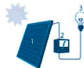
1. Zonnepaneel | 2. Omvormer | 3. Elektrische toestellen
