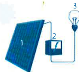
1 zonnepaneel | 2 omvormer 3 opwekking elektriciteit
