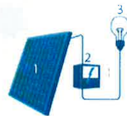
Zonnepanelen (1) omvormer (2) en licht (3)
