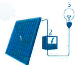
1 zonnepaneel 2 omvormer 3 elektriciteit
