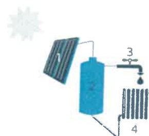
1 Zonnecollector 2 Zonneboiler 3 Sanitair warm water opslagvat 4 Radiator
